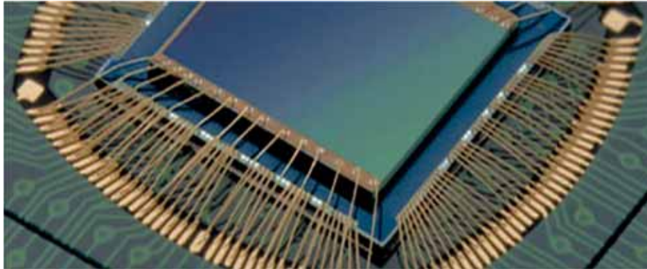
Figura 3 – Fios de ouro soldados no die de memória
